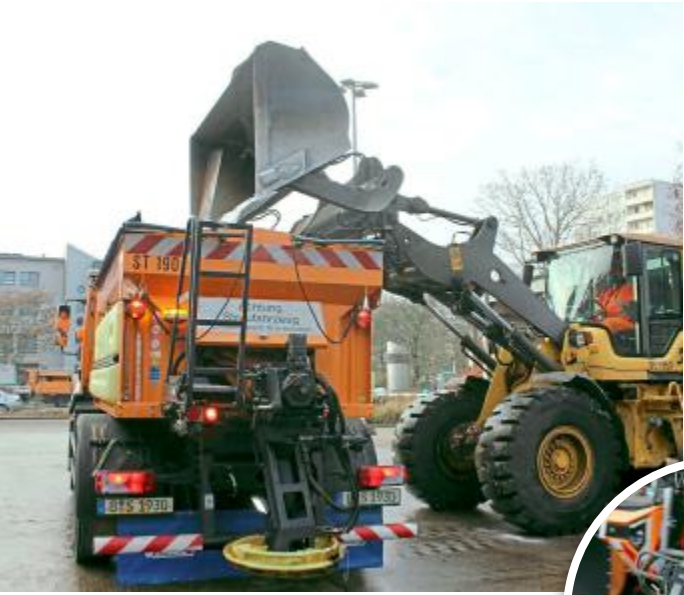
Von oben wird das Streufahrzeug mit Salz beladen. Der drehende Teller unten verteilt das Salz auf der Fahrbahn.
