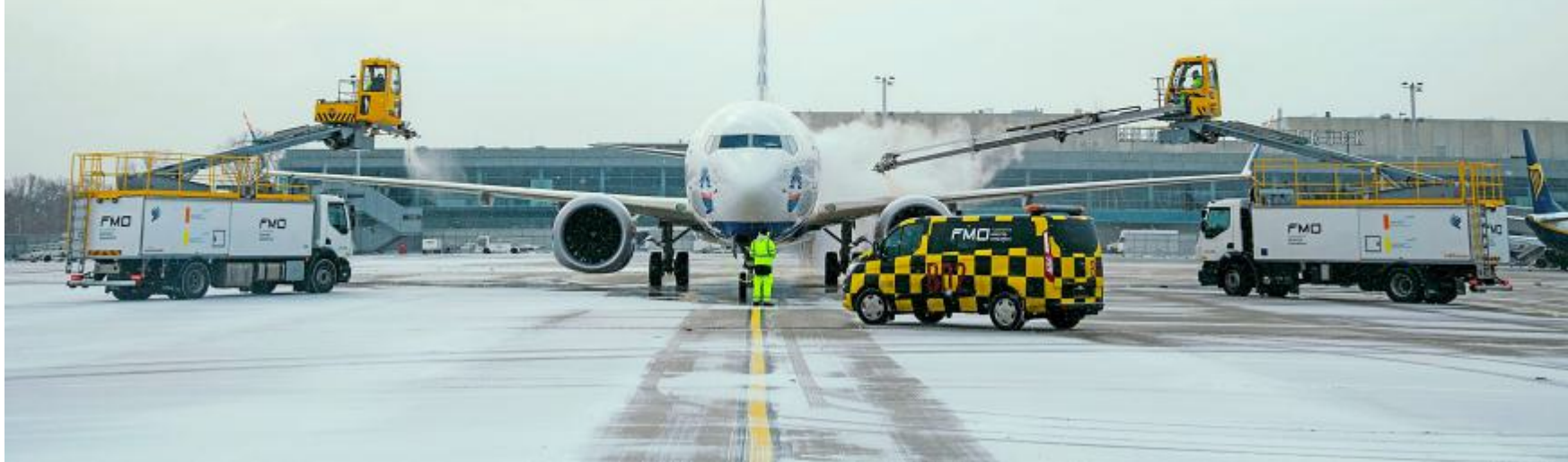
Von zwei Seiten nähern sich Enteisungsmaschinen der Boeing 737-8 von Sun Express. Nach gut zehn Minuten ist sie startklar.
